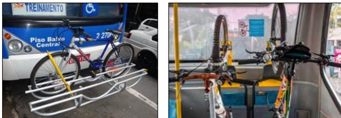
Figura 19 – Suporte externo e interno para o transporte de bicicletas em ônibus.
