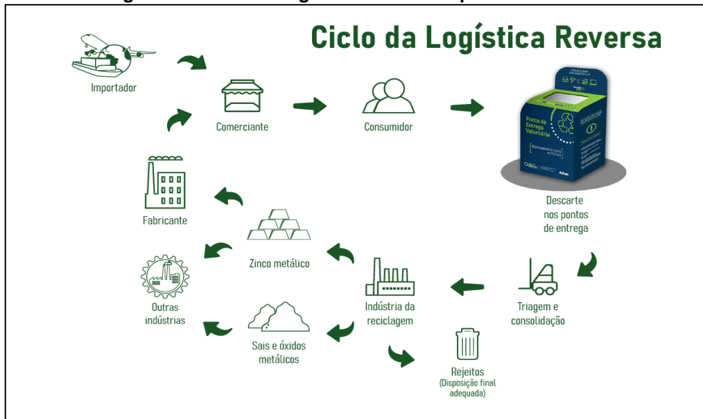
Figura 26 - Ciclo da logística reversa de pilhas e baterias.
