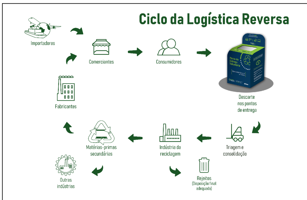
Figura 25 - Ciclo da logística reversa dos eletroeletrônicos e seus componentes.
