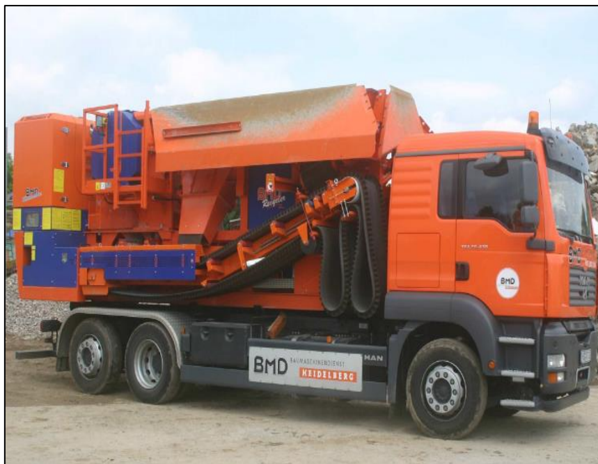
Figura 53 - Usina móvel de RCC.
